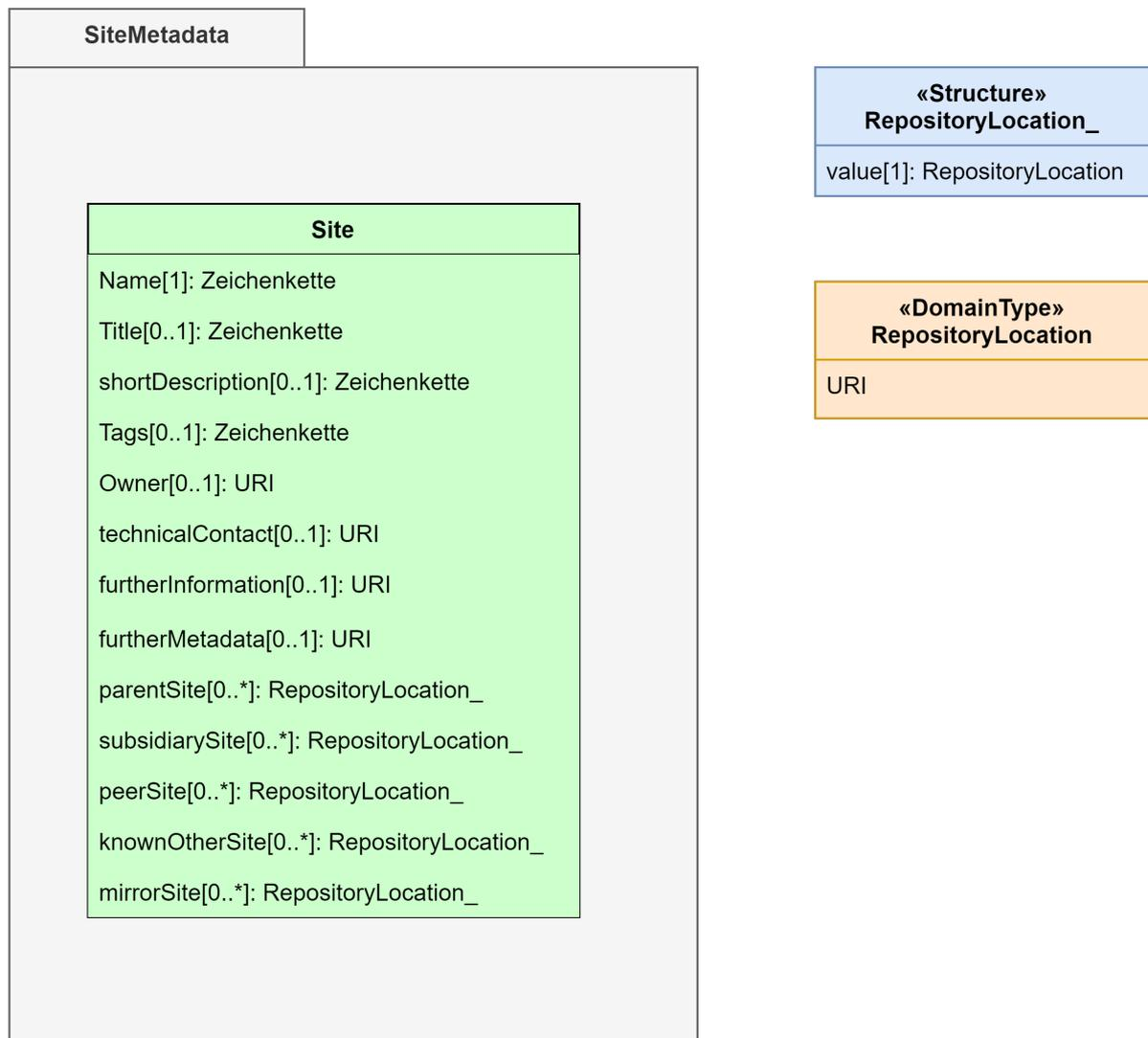
UML-Diagramm des Datenmodells *IliSite09*
