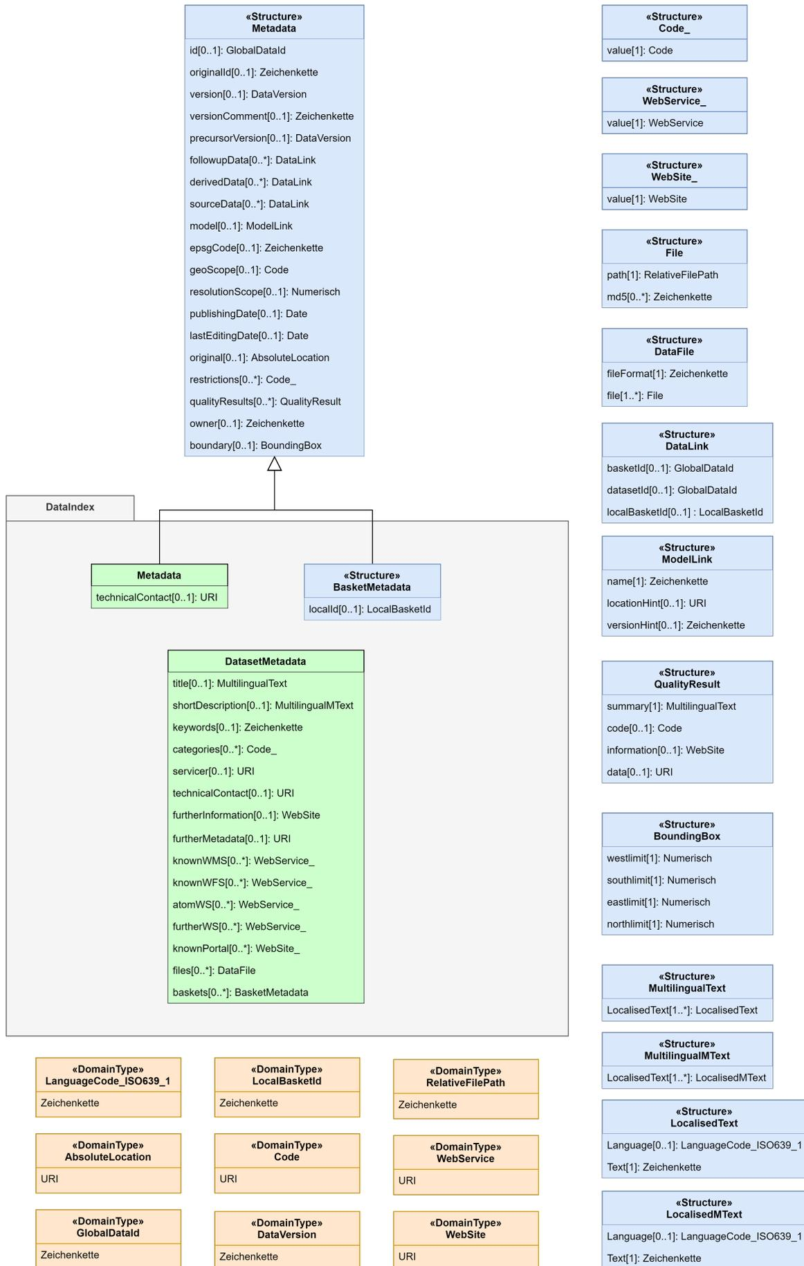
UML-Diagramm des Datenmodells *DatasetIdx16*
